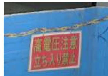
ワークも塗料も 帯電しているの で中は立入禁止 です
